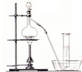
66-сурет. Азот (II) оксидін алуға арналған қондырғы.
